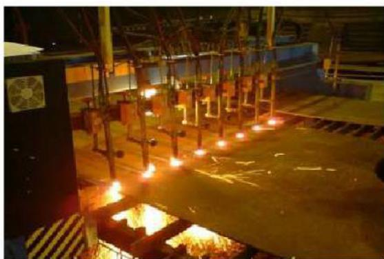
Раскрой листового металла на полосы нужной длины и ширины на установке газотермической резки с ЧПУ, которая позволяет распускать лист одновременно десятью резаками.
