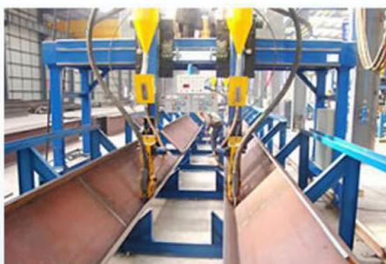
Во время сварки балка располагается на стапелях под углом 45 градусов, что обеспечивает хороший провар и катет шва. На портале смонтированы два комплекта сварочных головок, которые могут перемещаться в горизонтальном или вертикальном направлении вдоль портала.
