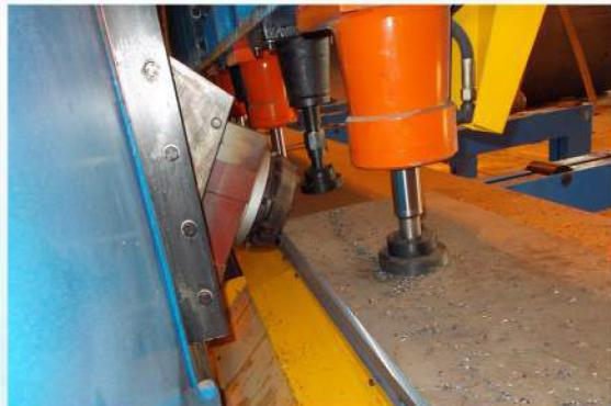
Производится для улучшения провара поясного шва при больших толщинах стенки на кромкофрезерном стане.
